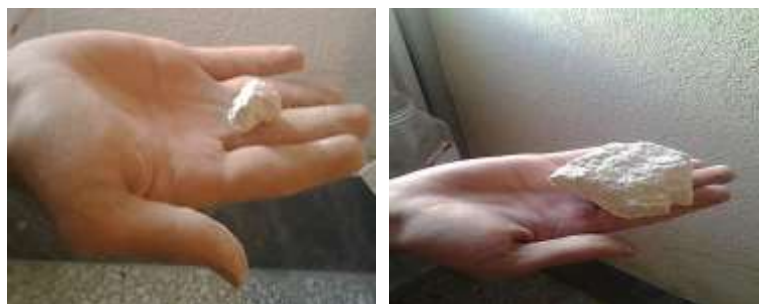
شکل ۲- نمونه‌هایی از پوکه معدنی با لایه‌بندی ۱ سانتی‌متر و ۵ سانتی‌متر
