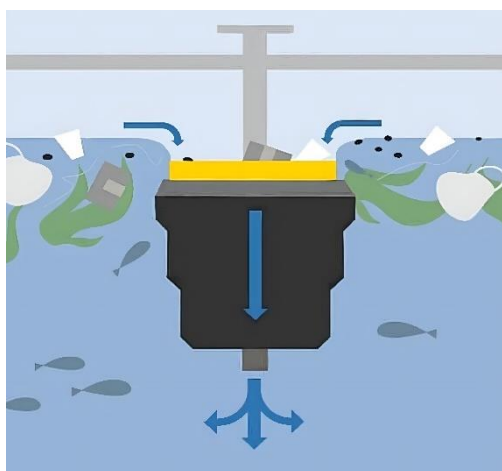
شکل ۱- مکانیسم Seabin (Parker-Jurd et al., 2022)
