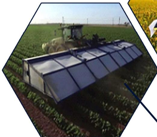
**Blue River LettuceBot2** این ربات ابزاری مناسب برای کشاورزانی است که کاهو کشت می‌کنند. این ربات با بهره‌گیری از سیستم پردازش تصویر در زمین‌های کاهو به وسیله اتصال به تراکتور حرکت کرده و از رشد علف‌های هرز مقاوم به علف‌کش جلوگیری می‌کند. به دلیل دقت بالای این ربات مصرف علف‌کش تا ۹۰ درصد کاهش می‌یابد.
