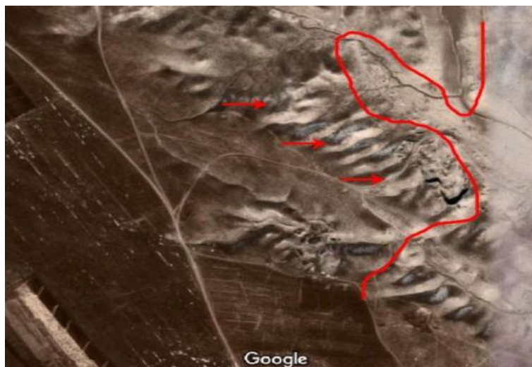
تصویر ۱۸ نمای هوایی یکی از دستکندهای آبراهی (کُلپَه) در خرّمی با ساختاری طولانی و پیچیده (مأخذ: وبگاه Google Earth)
