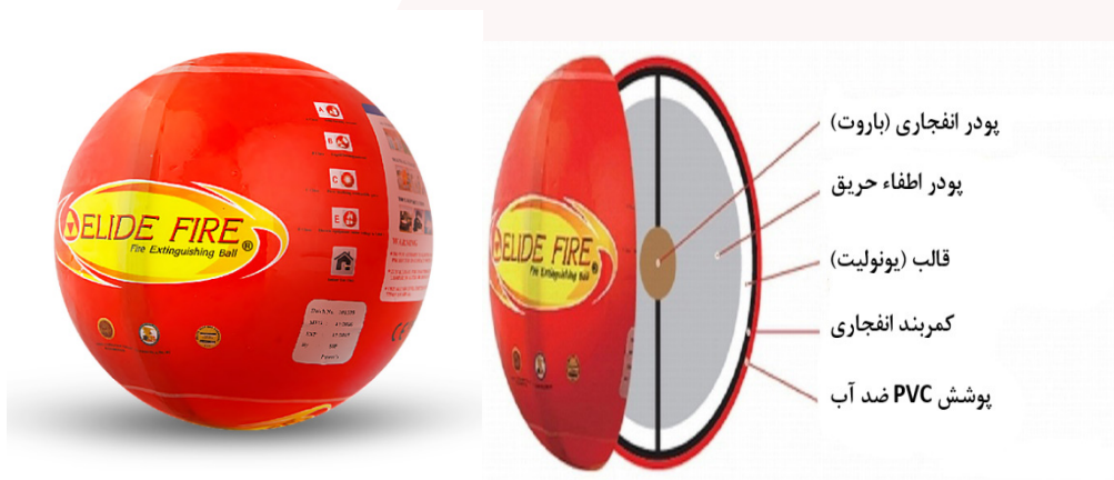
شکل ۶ - ساختار توپ های ضد حریق [۱۱]
