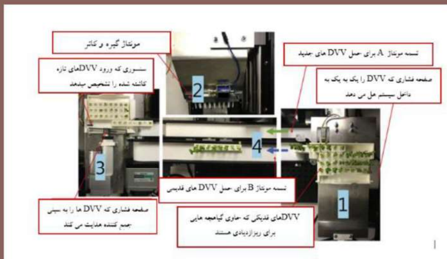
شکل ۸ - نمونه اولیه سیستم اتوماسیون ریز ازدیادی پیشنهادی (AMS) از نمای بالا؛ (۱) محفظه تغذیه، (۲) محفظه اصلی، (۳) محفظه جمع کننده، (۴) تسمه‌های مونتاژ.
